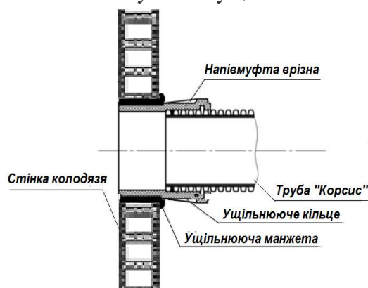
Мал 17. Під'єднання труби «Корсис»
